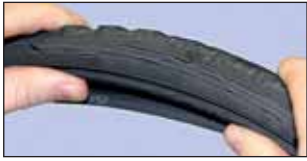
Scheuren door overbelasting
