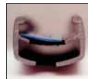
Het velglint is te smal en dekt het velgbed niet volledig af.
