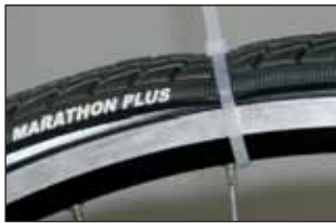
Een kabelbinder als helpende derde "hand".
