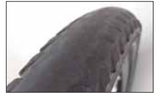
Het profiel is afgesleten. Het rubber is nog aanwezig. Met deze band kan men nog rijden.
