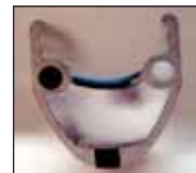
De afdekking door een 12 mm velglint is te krap en niet veilig.
